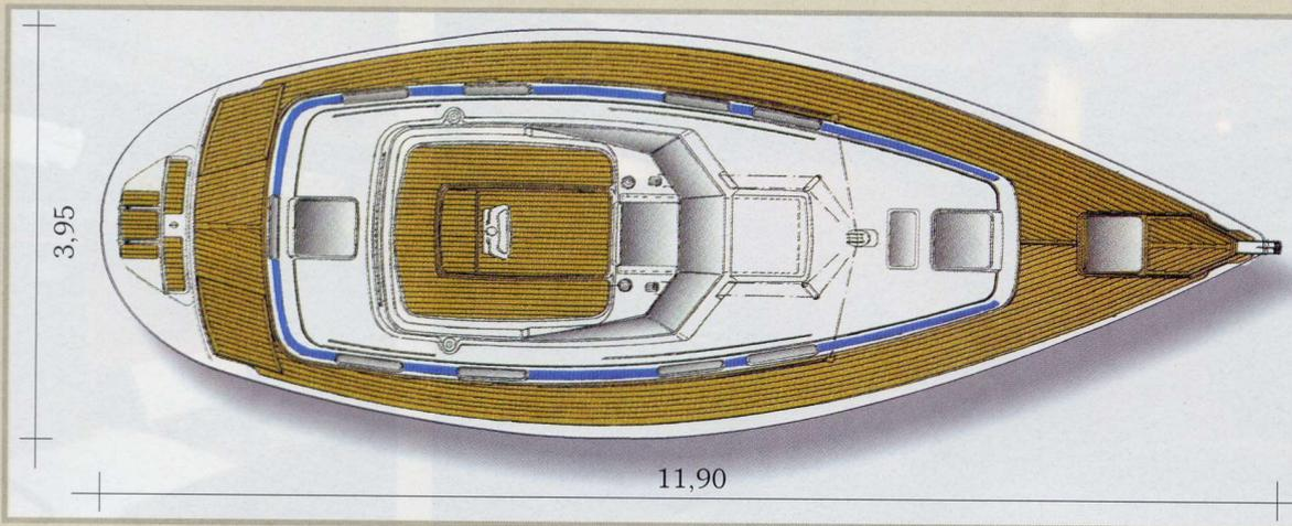
In queste pagine particolari della coperta, del pozzetto, della prua, molto ben lavorati. La zona timoniere è in grado di ospitare anche quattro persone oltre allo skipper. La timoneria a ruota ha diametro di 90 centimetri e i comandi motore monoleva sono situati sulla destra della timoneria stessa.
